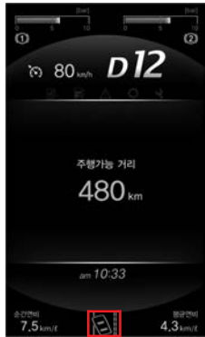
전방추돌 경고 시스템(FCW) OFF시 화면
