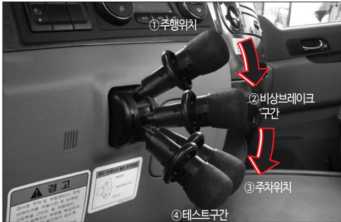
테스트 구간이 있는 주차 브레이크 (트랙터, 풀카고 차량)
