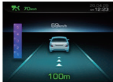
모드 설정 상태와 앞차의 속도와 거리를 표현합니다.
