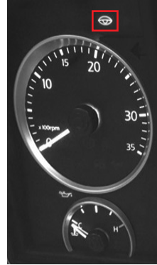
동공인식 졸음 경고 시스템(DSM) OFF시 화면
