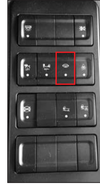
동공인식 졸음 경고 시스템(DSM) ON 스위치
