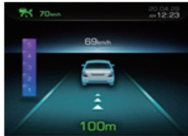
모드 설정 상태와 앞차의 속도와 거리를 표현합니다.
