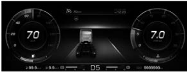
차선이탈 경고 시스템(LDW) "ON"시 화면
