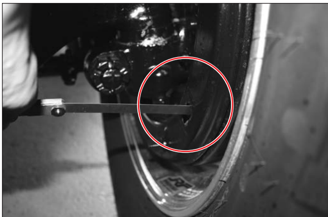
(1) EBS 미장착 : 브레이크 라이닝 마모점검 브레이크 라이닝의 마모점검은 더스트커버의 점검구를 통해서 쉽게 점검할 수 있습니다.
