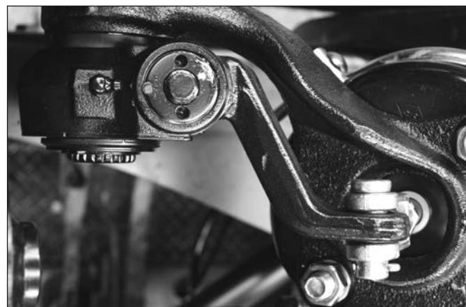
(2) 자동라이닝 조정장치 자동라이닝 간극조정 장치는 브레이크 라이닝 마모에 따른 간극조정을 자동으로 하는 장치입니다.
