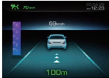
모드 설정 상태와 앞차의 속도와 거리를 표현합니다.
