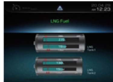
LNG탱크는 LNG 차량에서만 표시됩니다.
