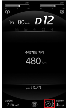
차선이탈 경고 시스템(LDW) OFF시 화면
