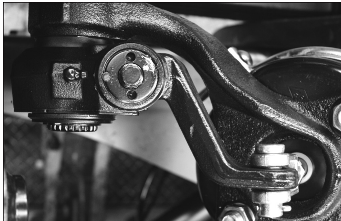
(2) 자동라이닝 조정장치 자동라이닝 간극조정 장치는 브레이크 라이닝 마모에 따른 간극조정을 자동으로 하는 장치입니다.
