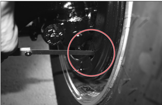
(1) 브레이크 라이닝 마모점검 브레이크 라이닝의 마모점검은 더스트커버의 점검구를 통해서 쉽게 점검할 수 있습니다.
