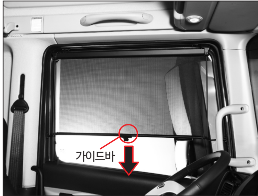
사이드 선바이저를 내릴때는 가이드바를 손으로 잡고 아래 방향으로 당겨주십시오.
