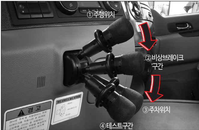
테스트구간이 있는 주차 브레이크 (트랙터, 풀카고차량)
