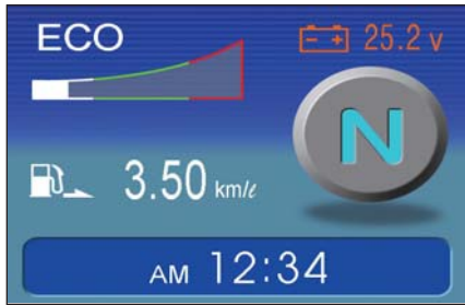
(1) 초기 시동스위치 “ON” 후 체크 경고등이 사라진 후 TFT-LCD 디스플레이 표현으로서 중립상태를 나타냅니다. - “N” 표시는 시스템 자동 점검 후 나타납니다.
