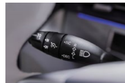
좌측 콤비네이션 스위치 등화류 조작 및 크루즈 컨트롤 작동
