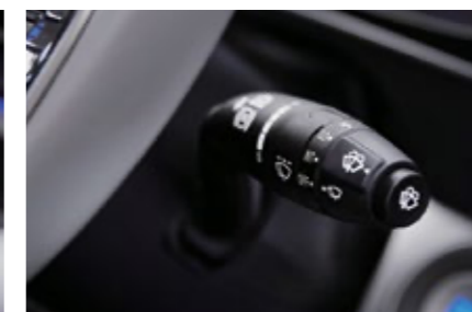
우측 콤비네이션 스위치 와이퍼 조작 및 보조 브레이크 작동
